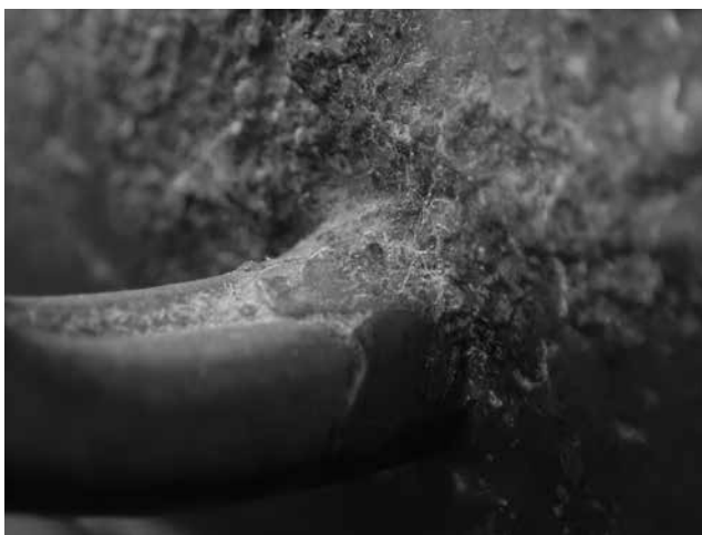
図3 銅の把手基部にある先鑄の痕跡
