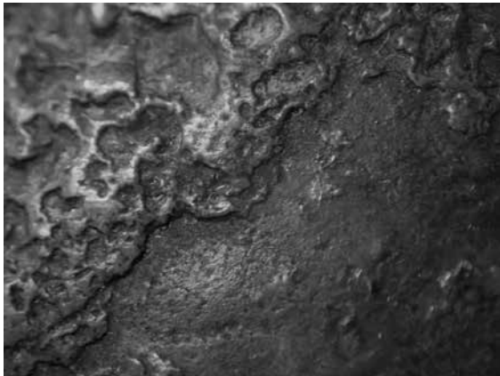
図5 鉶の表面に塗布された人工鍍
